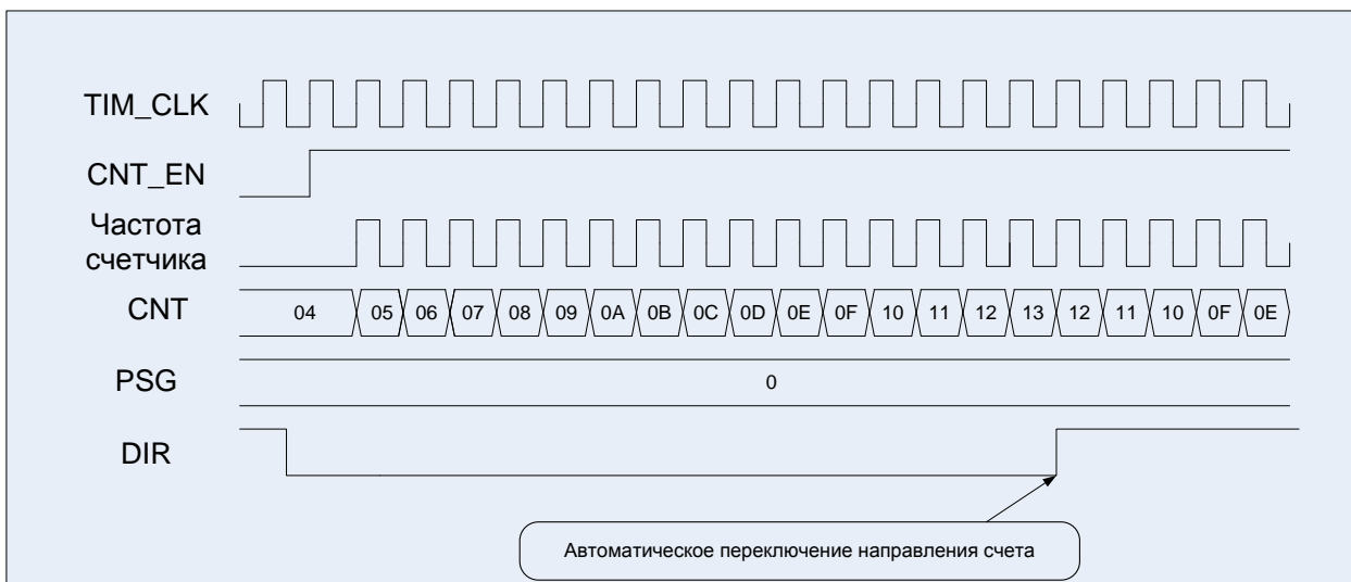
Рисунок 36 Диаграммы работы таймера, счет вверх/вниз, сначала вверх
