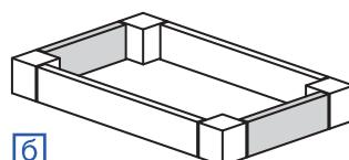
Предназначен для монтажа напольного распределительного шкафа к полу. Высота цоколя 100, 200 мм. Состоит из передних, задних и боковых элементов
