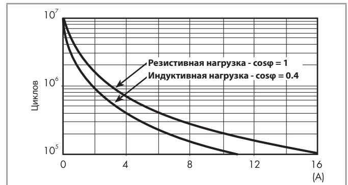
F 46 - Электрическая долговечность (AC) при ном. нагрузке Тип 46.61
