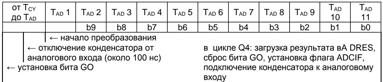
Рисунок 44 – Работа модуля АЦП по тактам
