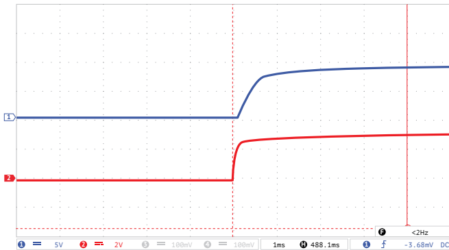
Рис. 7 (а). Осциллограмма установления выходного напряжения с момента подачи команды дистанционного управления.
