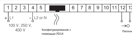
Рис. 4. Схема электрических соединений для приборов N25Z, N25H для измерения напряжения (для измерения частоты - только для приборов N25Z)
