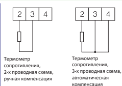
Рис. 1. Схема электрических соединений для приборов N25S
