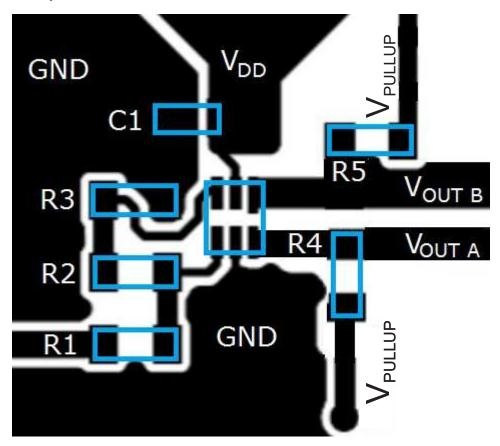
Figure 23. TLV6700-Q1 Layout Schematic
