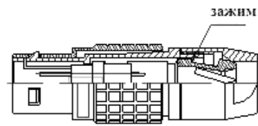
Вилка без резинового кожуха для кабеля
