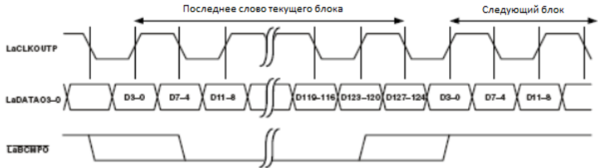
Рисунок 60 – Порт связи “а” передает порту связи “b” с завершением блока (новый блок из порта связи “а” следует немедленно после завершения первого блока)
