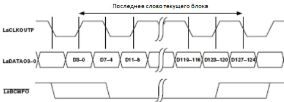
Рисунок 59 – Порт связи “а” передает порту связи “b” с завершением блока
